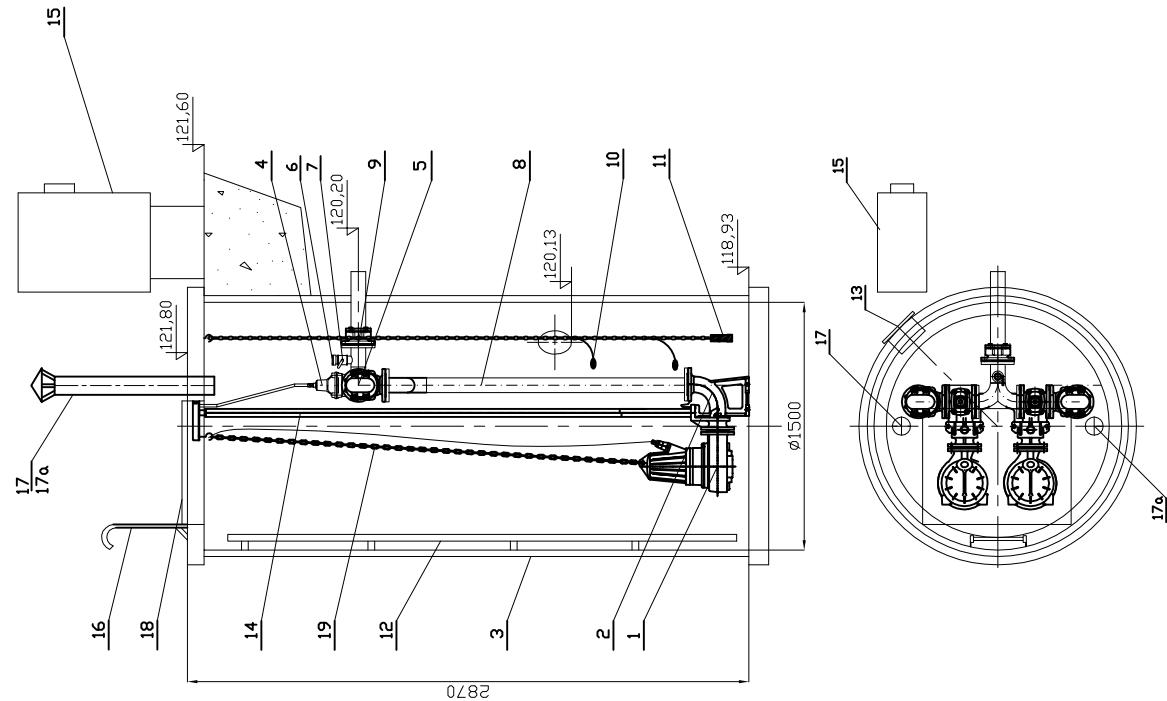
UWAGA: Zbiornik pompowni ścieków z polymeru oleotonu
